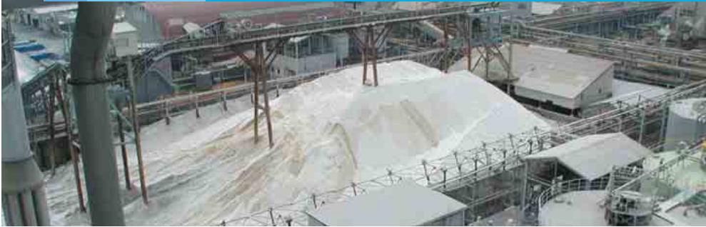
◀ソーダ灰の製造プラント。中央にあるのはソーダ灰の原料の原塩。
