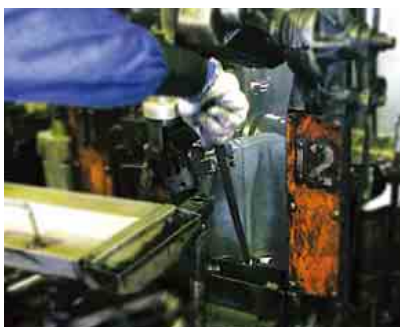
金型の塗油作業風景
