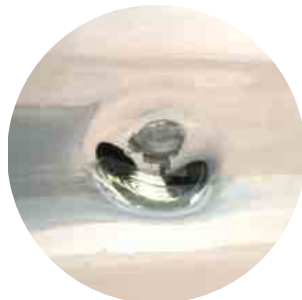
▲レンガの破片が混入した不良びん
